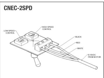
0-10V REMOTE POT DOES NOT DISCONNECT POWER FROM MOTOR ONLY SETS MOTOR TO ZERO RPM
